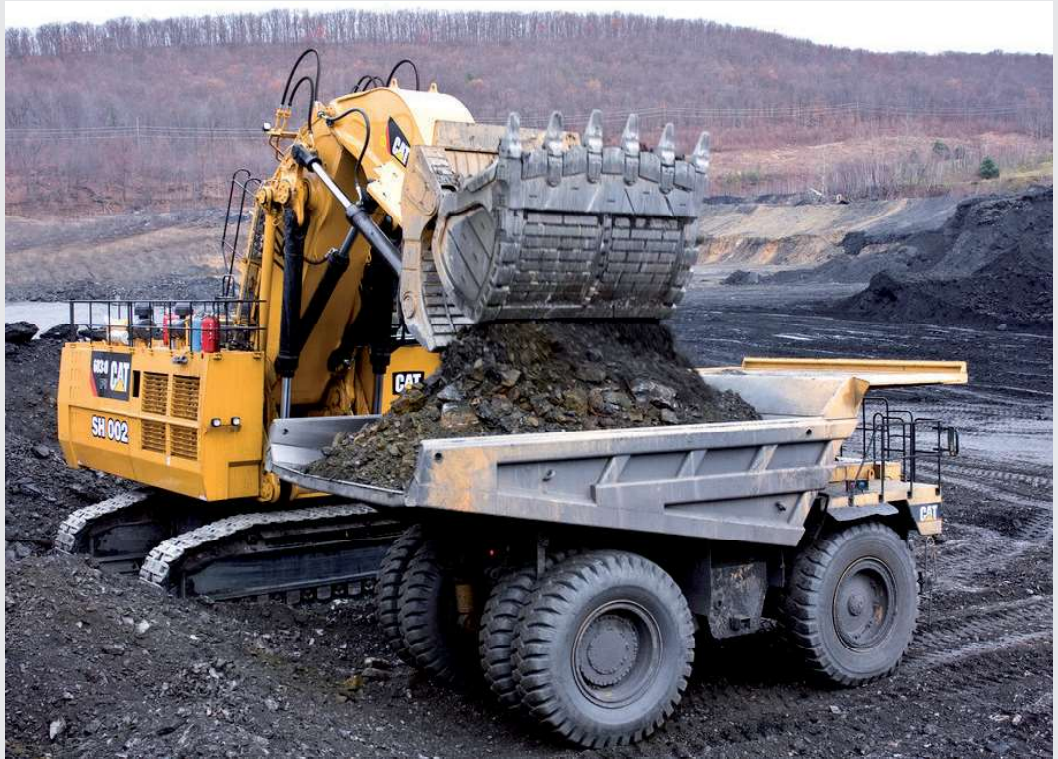
Blindaje de balde de pala y tolva de camión.
